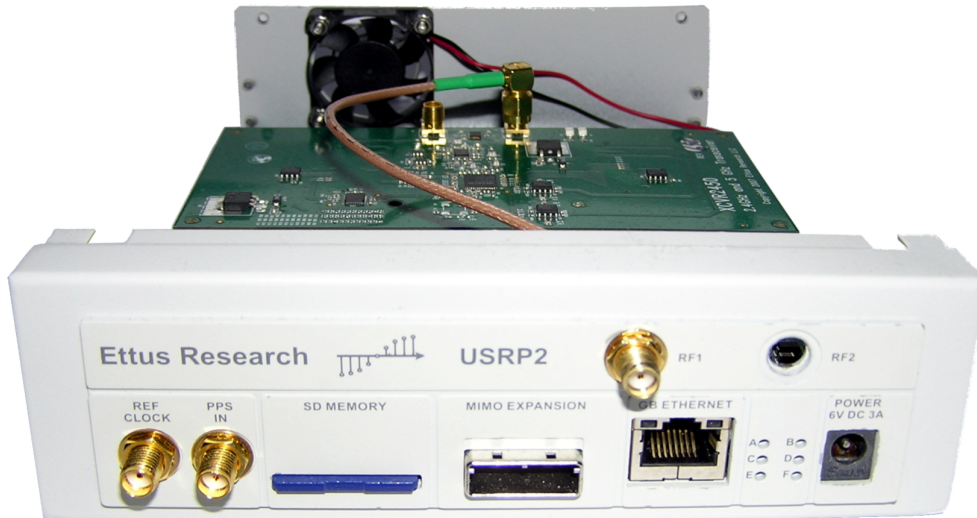
Abbildung 4.2.: Das zur Überwachung des Drahtlosmediums verwendete USRP 2 von Ettus Research
