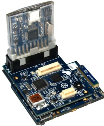
Abbildung 3.3: Imote2 mit Interface Board und JTAGKey-Tiny
